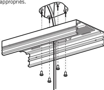
2. Installer le transformateur dans le profil de base, à l'aide de vis M4, au-dessus des canaux longitudinaux.
