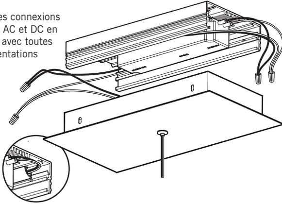
5. Fixer la plaque de la canopée et l'ensemble de couvercle à la base en utilisant des vis.
